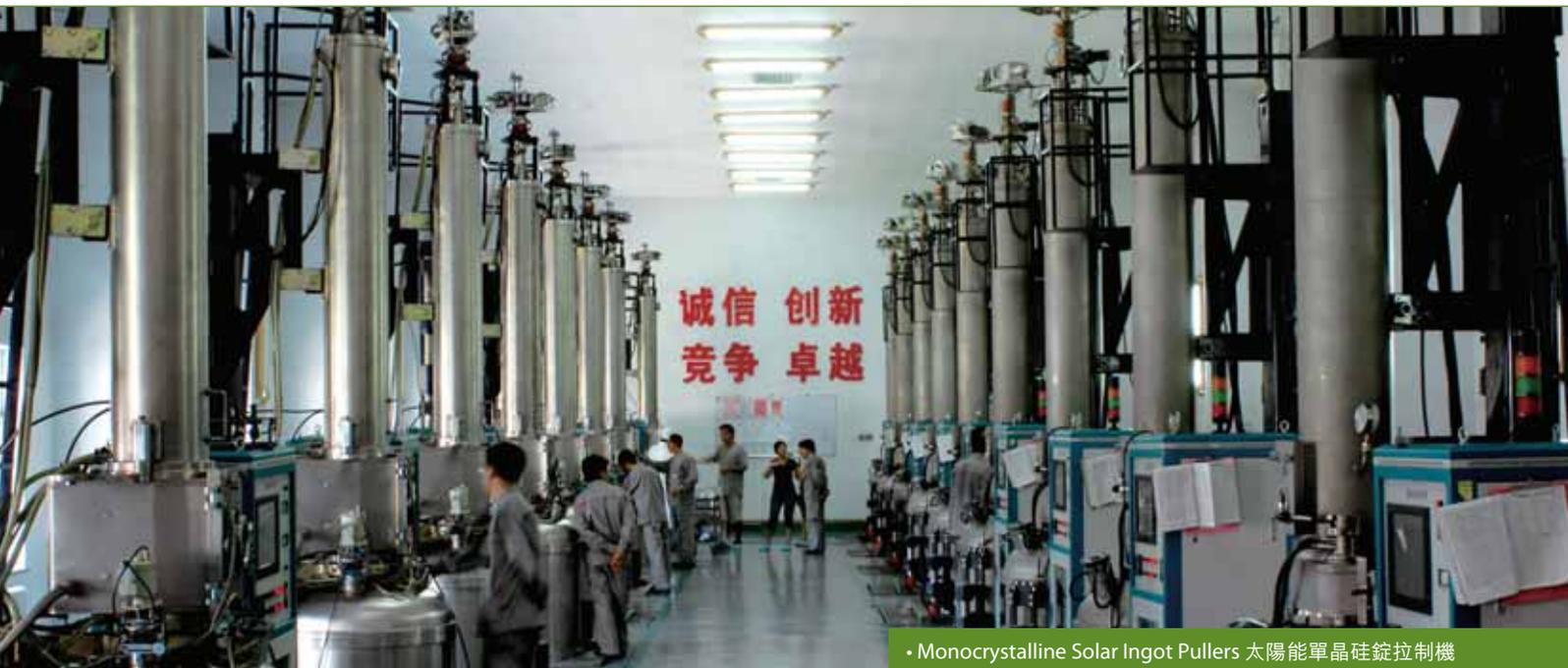
• Monocrystalline Solar Ingot Pullers 太陽能單晶硅錠拉制機
