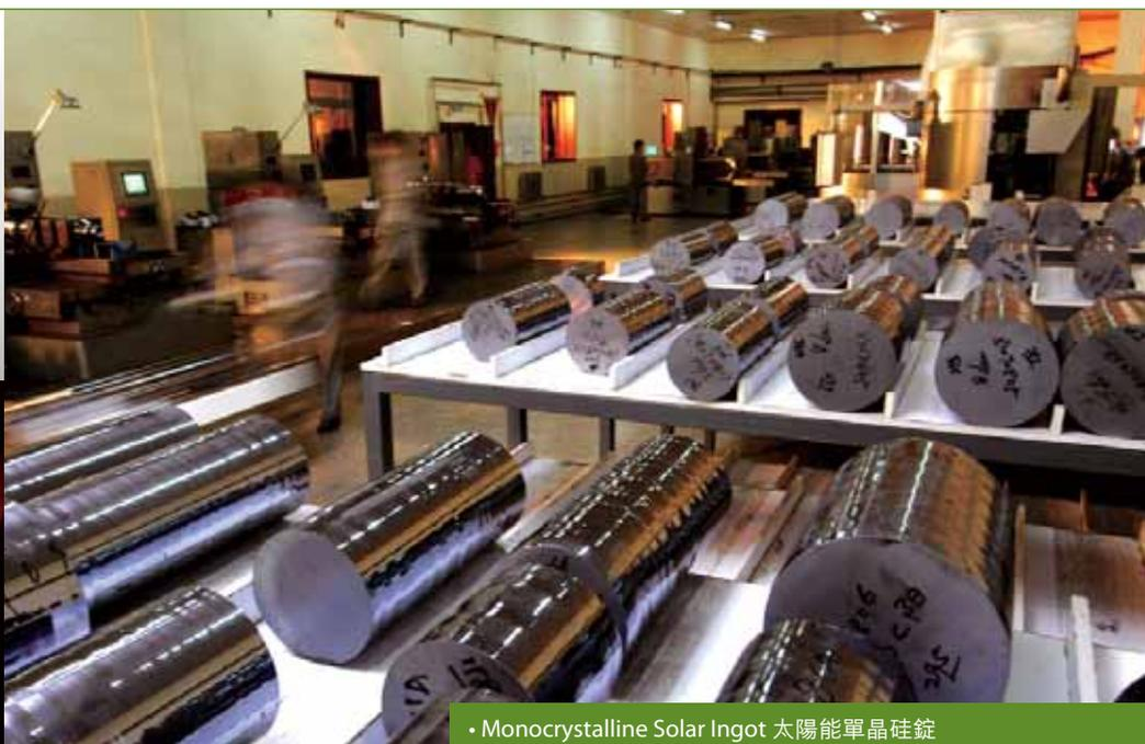
• Monocrystalline Solar Ingot 太陽能單晶硅錠
