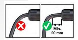
图 5-8 电缆布线图
