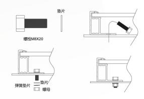
图 5-1 螺栓安装详细图
